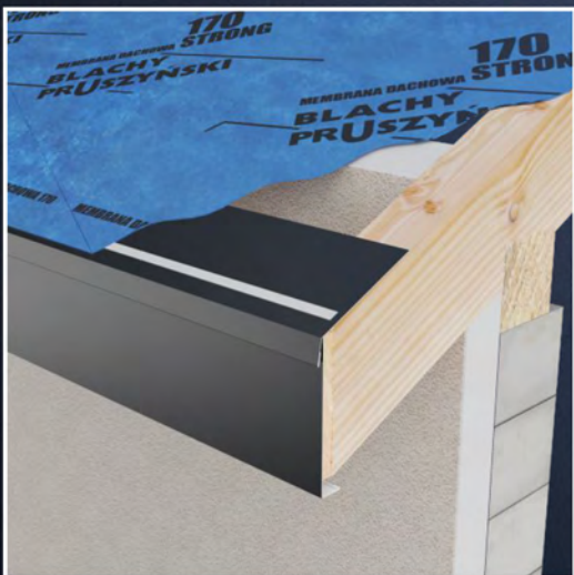
Instalarea membranei anticondens pe căpriori; Membrana se lipește de flanșa jgheabului.
