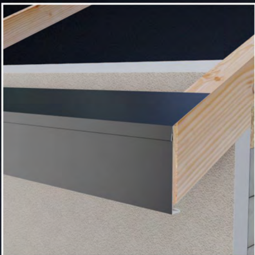
Instalarea benzii sub folia de condens.
